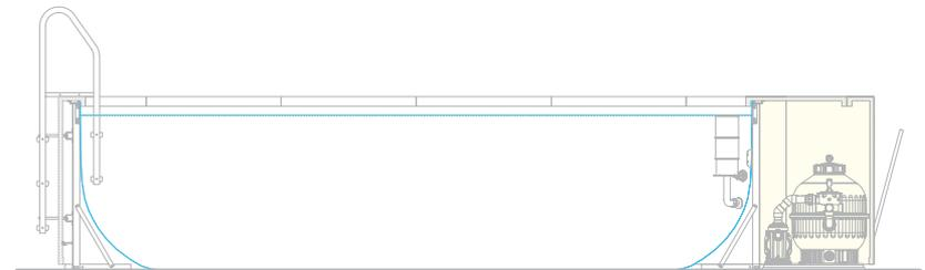
Großer integrierter und leicht zugänglicher Technikraum mit einer Länge von 3 - 4 m entsprechend der Beckenbreite.
